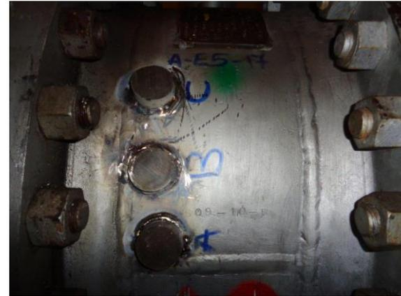
Si sono concluse le analisi radiochimiche dei campioni metallici prelevati dai sistemi ausiliari ai fini della caratterizzazione dei materiali da smantellare.
