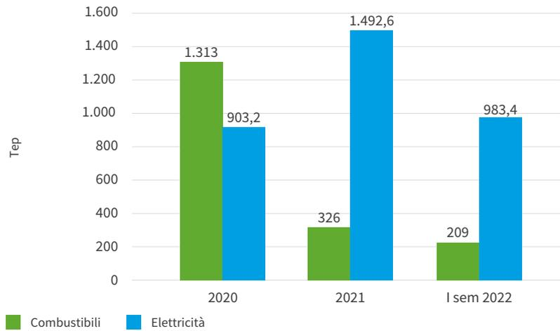
Il trend dei consumi di combustibile ha subito un aumento nel 2020, in quanto a partire da settembre 2019, a causa dell'indisponibilità della linea elettrica principale, l'alimentazione elettrica è stata fornita tramite gruppi diesel di emergenza, con un conseguente decremento dell'utilizzo di energia elettrica. L'alimentazione esterna è stata ripristinata a luglio 2020, cui ha fatto seguito lo spegnimento del generatore di emergenza. Nel 2021 il consumo di gasolio è tornato ai livelli del 2019.
