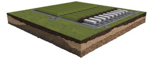
Struttura artificiale disposta a copertura delle celle. Viene realizzata con strati di diversi materiali allo scopo di impedire infiltrazioni di acque piovane, isolare i rifiuti dall'ambiente e migliorare l'impatto visivo della struttura.
