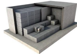
In ogni cella di cemento armato (27 m x 15,5 m x 10 m), progettata per resistere almeno 350 anni, vengono inseriti 240 moduli
