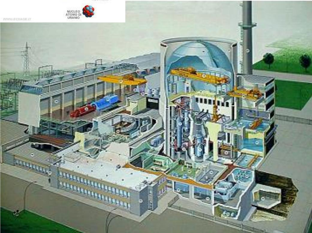
Nelle Centrali nucleari PWR come la Centrale di Trino, il calore generato dalle **reazioni di fissione** dell'Uranio nel reattore è raccolto dall'acqua del circuito primario (pressione 140.6 kg/cm<sup>2</sup>).
