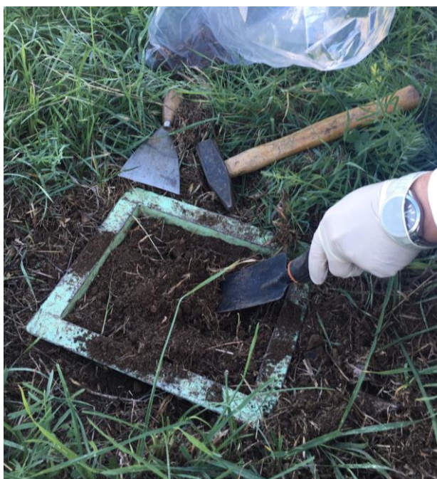
Figura 23 - Campionamento di terreno effettuato per mezzo di una dima di area 25 \times 20 \text{ cm}^2 e spessore 10 cm.
