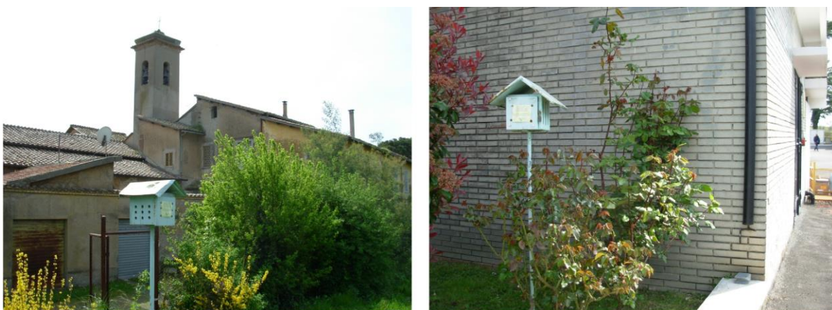
Figura 19 - Stazioni poste ad 1.5 m dal suolo utilizzate per l'ubicazione delle due coppie dei dosimetri a termoluminescenza. A sinistra è mostrata la stazione presente nel punto n° 17 della rete, esterna al Centro, mentre a destra è mostrata la stazione presente nel punto n° 1 della rete, interno al Centro.
