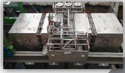
Taglio del monolite e montaggio dei coperchi dei semi-contenitori
