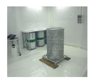
Completato il riconfezionamento e trattamento di 303 fusti appartenenti al cosiddetto **lotto III** e di 256 fusti di tipo **de minimis**, ovvero contenenti rifiuti radioattivi la cui attività residua è ormai decaduta al di sotto dei livelli di allontanamento. Il riconfezionamento e trattamento dei fusti del lotto III ha prodotto 907 nuovi fusti da 220 litri dei quali 330 sono stati supercompattati dall'impianto NUCLECO ed inseriti in 89 fusti overpack da 380 litri rientrati a Trino.
