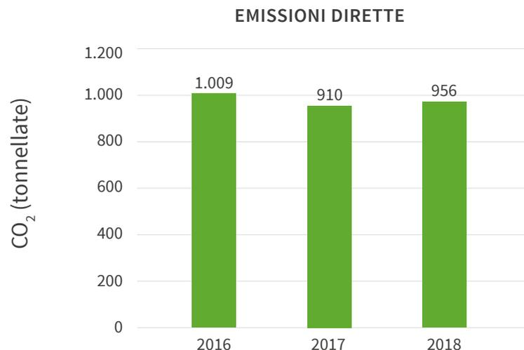
Nel corso del 2018 sono aumentate le emissioni dirette per la parte che riguarda le fughe di F-Gas, si sono verificate perdite di gas in alcune macchine. Il gas disperso in atmosfera è stato reintegrato nei circuiti frigoriferi con nuovo gas tramite intervento da parte di ditta abilitata.
