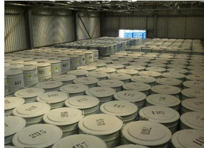
A fine settembre 2015 sono riprese le attività di supercompattazione dei rifiuti radioattivi solidi, con una produzione di 592 overpack.
