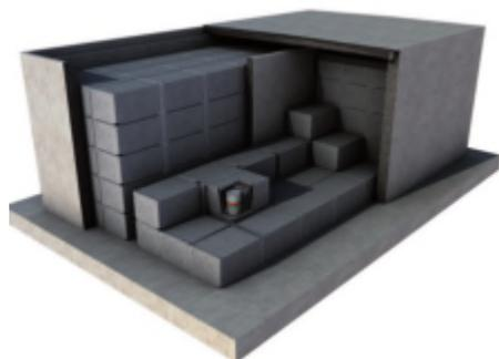
I moduli vengono a loro volta inseriti in celle di cemento armato 27m x 15,5 m x 10 m (**TERZA BARRIERA**), garantite per 350 anni
