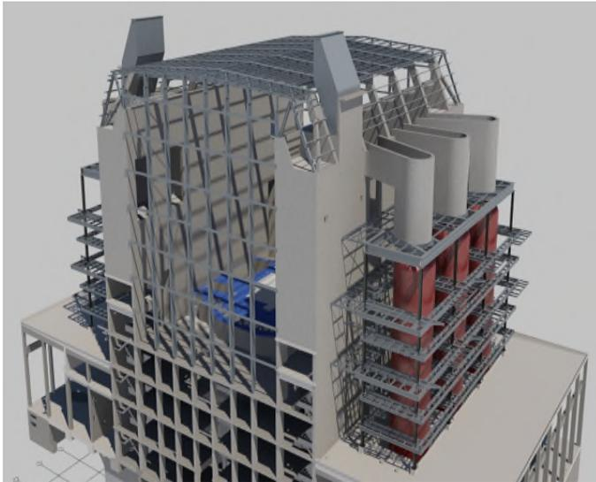
Le informazioni contenute in più di 4.000 disegni costruttivi e foto sono state esaminate e tradotte in modelli CAD, FEM e DB.
