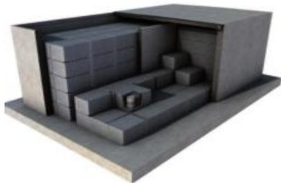
I moduli vengono a loro volta inseriti in celle di cemento armato 27m x 15,5 m x 10 m (**TERZA BARRIERA**), garantite per 350 anni
