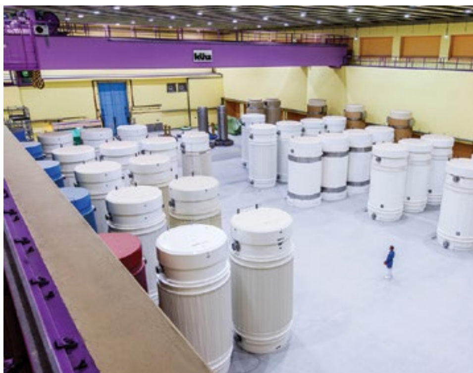
Cask per lo stoccaggio dei rifiuti ad alta attività - Zwiilag, Svizzera
