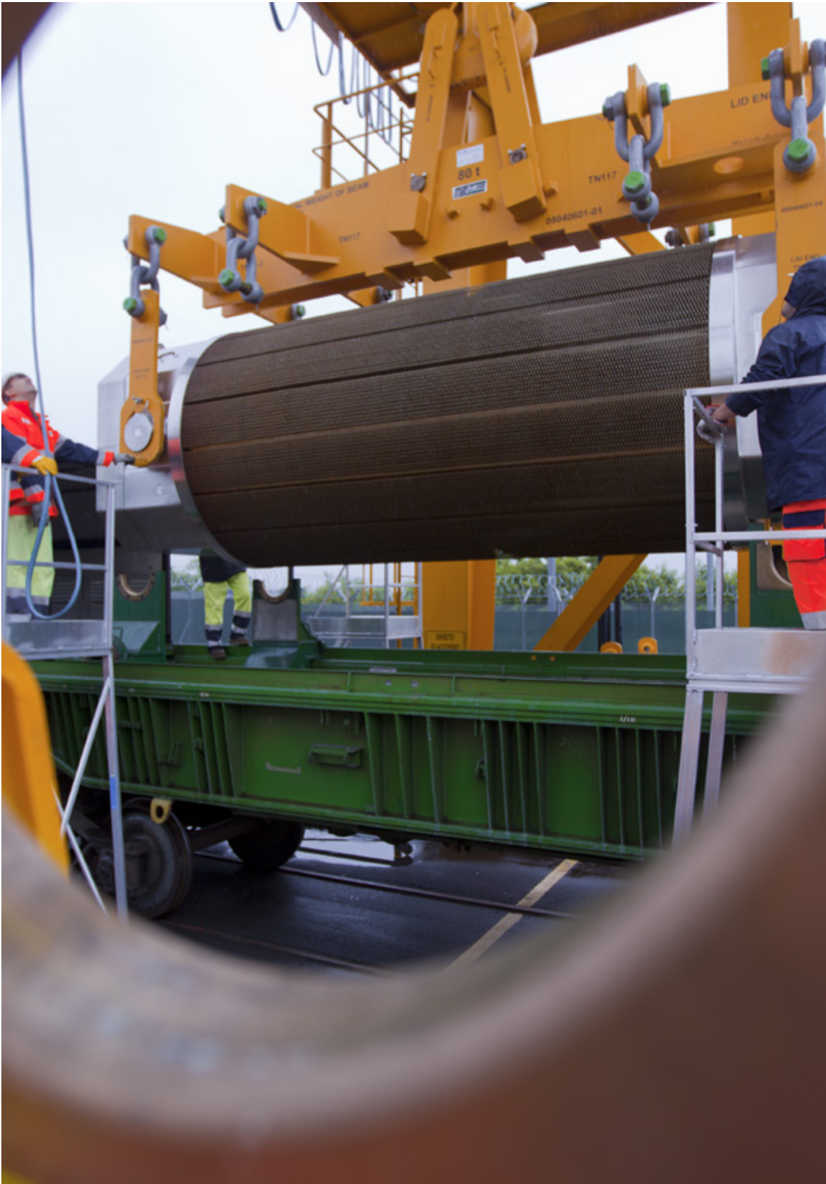
Trasporto del combustibile irraggiato della centrale
